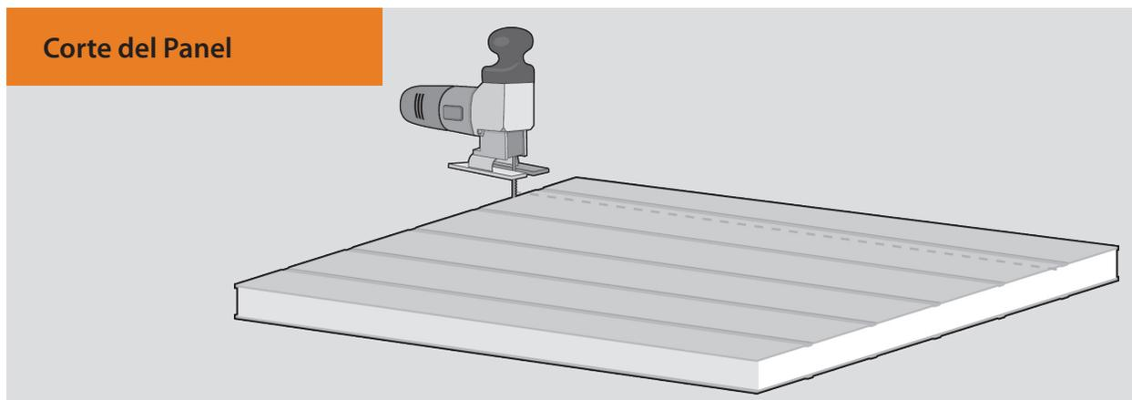
Nota: Se sugiere marcar el panel con Chalk Line por ambos lados, cortar con la sierra sable sin traspasar completamente el panel, girar y terminar de cortar, esto para que el corte sea lo más exacto posible.
