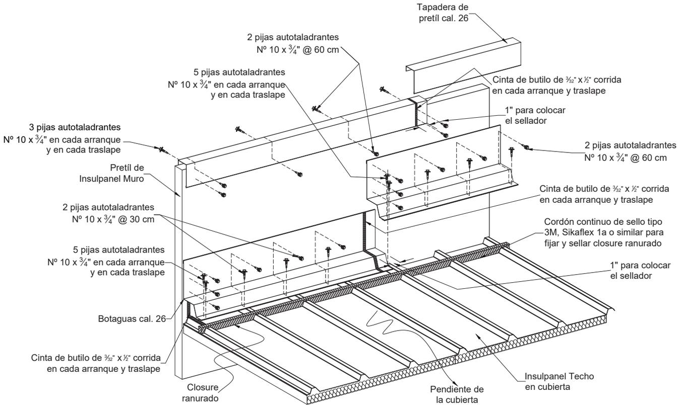
**Detalle Unión Insulpanel® Techo**
