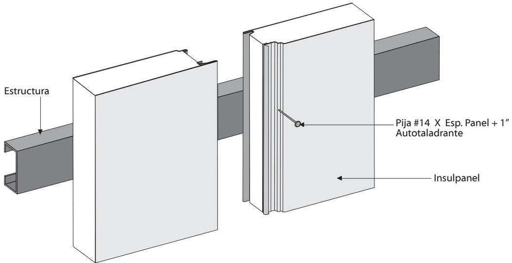
**Fijación de Insulpanel® Muro Hidden Fix para espesores mayores a 5"**
