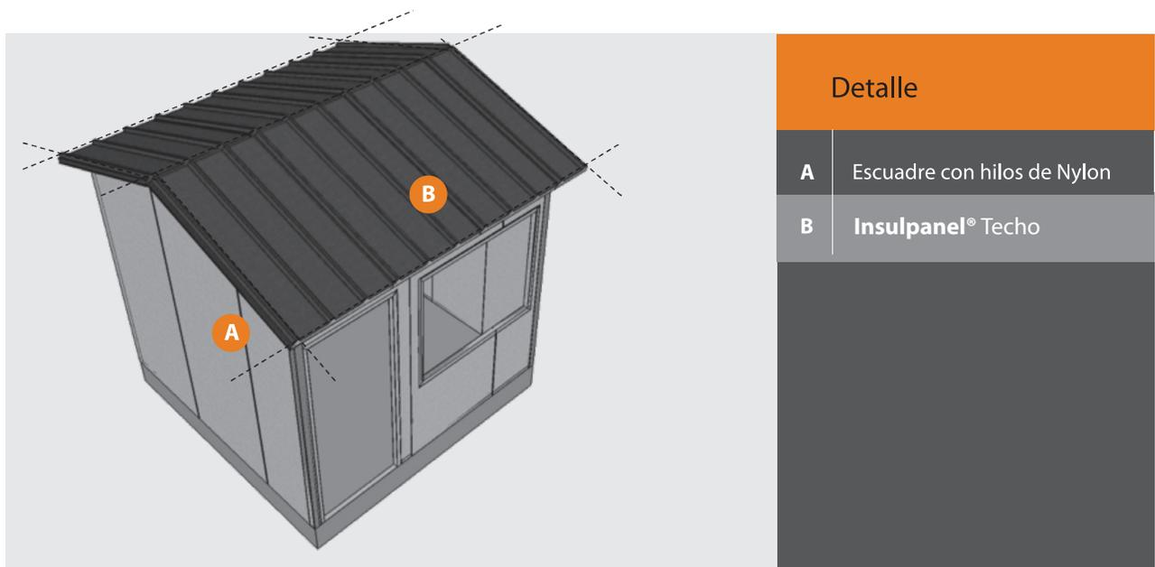
Insulpanel® Techo cuenta con una cuarta cresta sin aislamiento utilizada para realizar la unión entre paneles. Para garantizar el sellado de esta junta lateral, se especifica la colocación de pijas autotaladrantes N°14 x 7/8" @ 60 cm con un sello de butílo de ½" entre las crestas.
