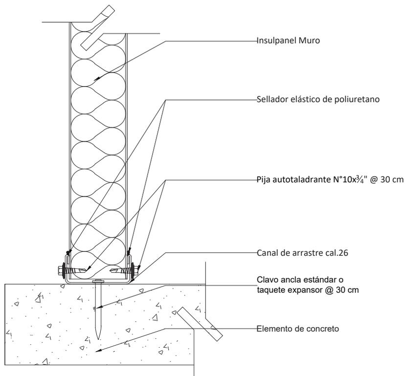
**Fijación de Insulpanel® Muro Hidden Fix para espesores menores a 5"**
