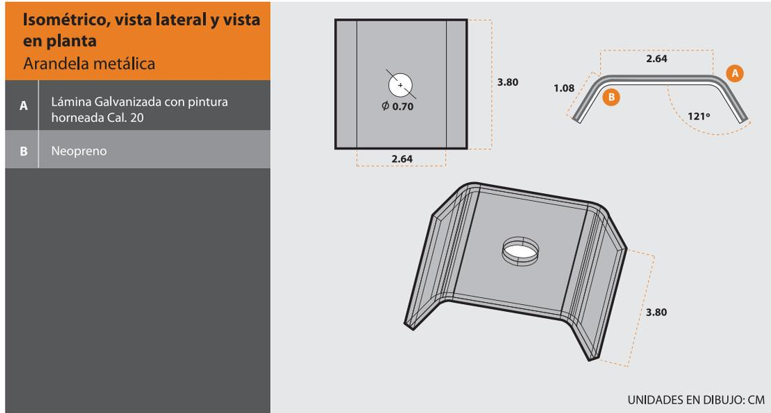
Nota: Este accesorio se coloca en la parte superior de la cresta, fijado con una pija #14 con una longitud equivalente al espesor del panel más 3".
