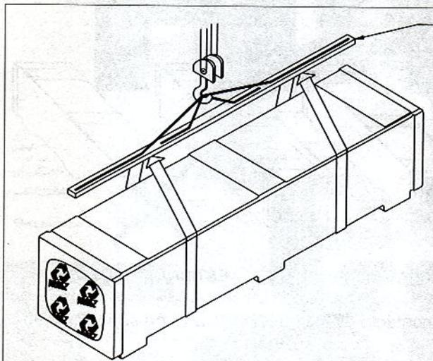
BALANCIN DE 6 MTS. PARA REPARTIR UNIFORMEMENTE EL PESO DEL PAQUETE AL MOMENTO DE LEVANTARLO.
